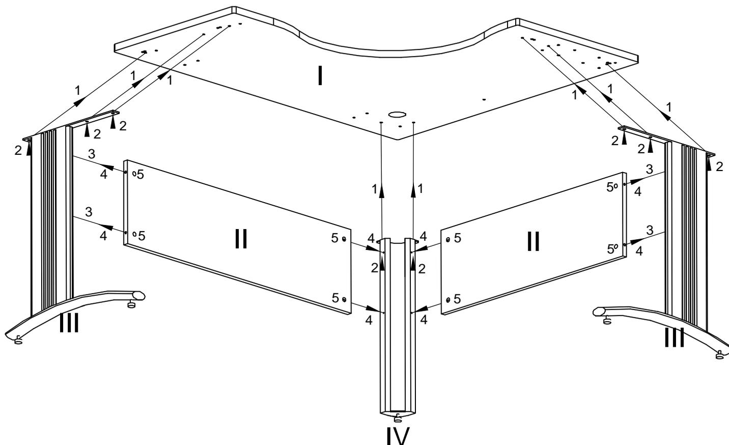
1. При сборке стола в комплекте с передними панелями ФРПД-14Э/16Э вкрутить дюбеля стяжек (4) в опоры стола (III) используя шайбы (3), и в угловую опору (IV) без использования шайб.
