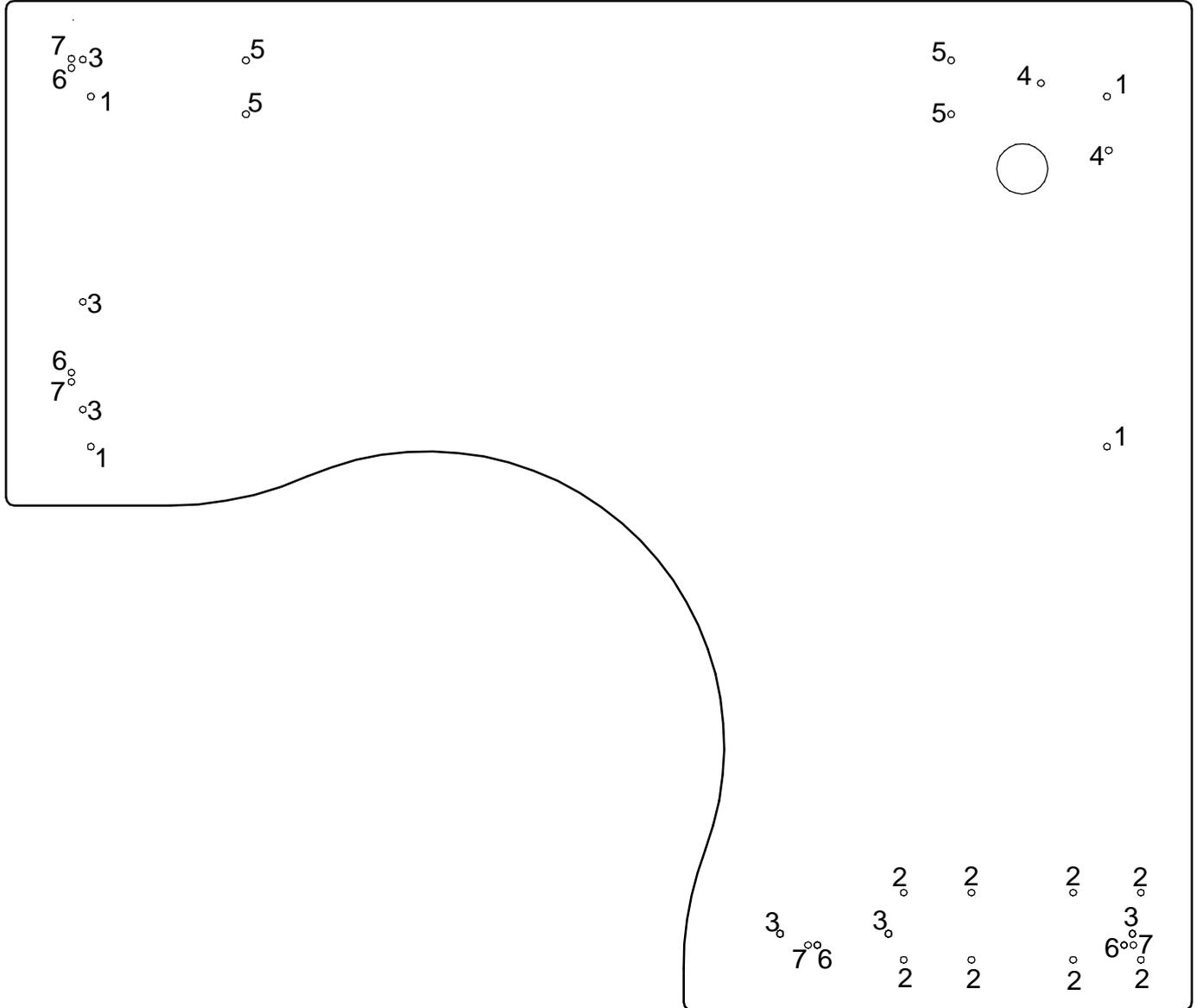
Положить столешницу отверстиями вверх. В зависимости от устанавливаемых опор, вкрутить футорки (1) (для ОТЦСЭ-14;16, ОРСЭ-75 забить футорки (2)), из комплекта фурнитуры опор, в соответствующие отверстия:
