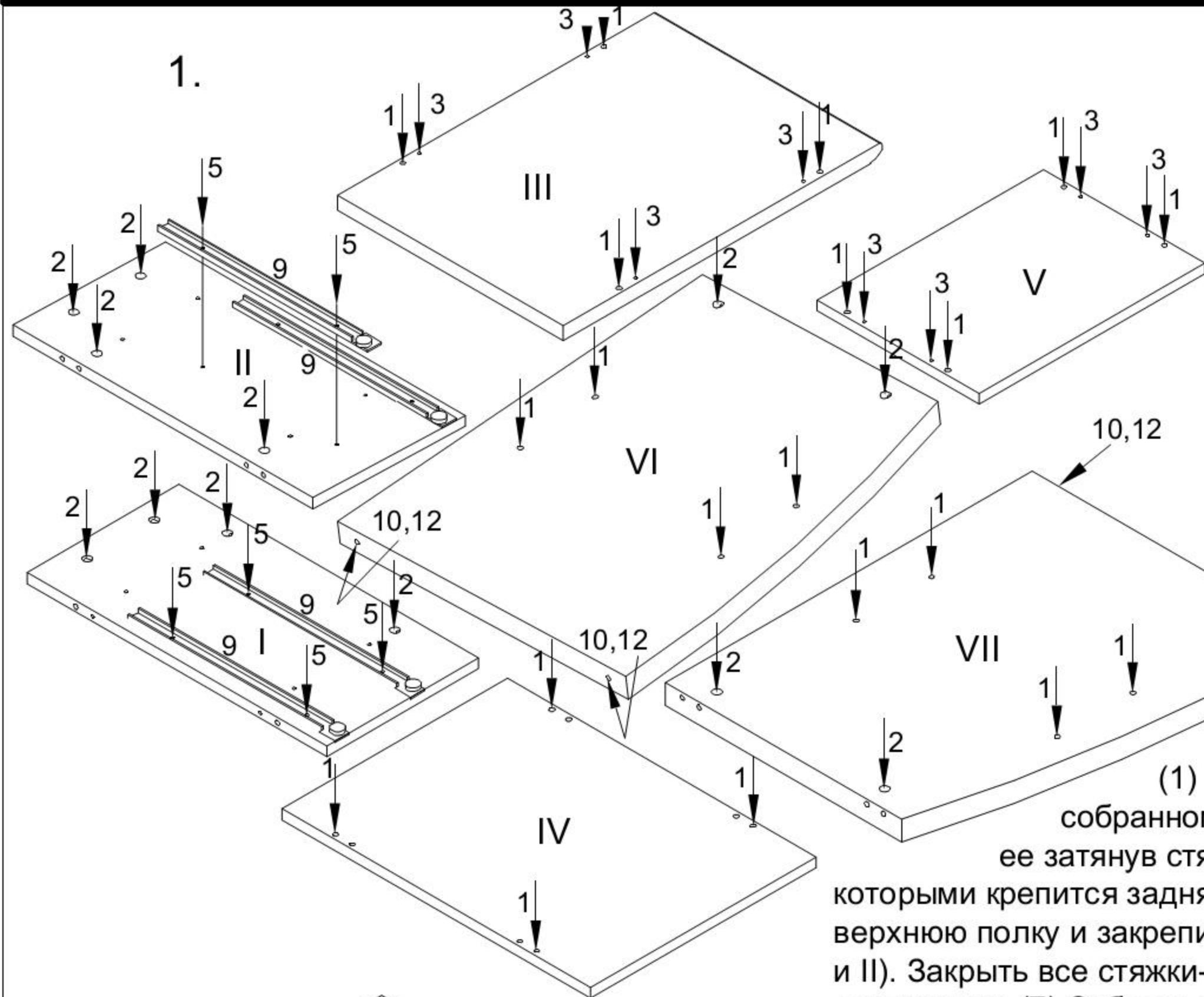
Положить боковины, верхнюю и нижнюю полки и заднюю стенку отверстиями вверх. Забить в верхнюю и нижнюю полки, заднюю стенку и боковины шканты (1), ввернуть дюбеля (3) стяжек-эксцентриков. В боковины вставить стяжки-эксцентрики (2) стрелкой в направлении отверстий на торцах, впрессовать крепежи для опор (10) и ввернуть в них опоры (12). К боковинам привернуть направляющие роликовые (9) евровинтами (5) (см. рис 1).
