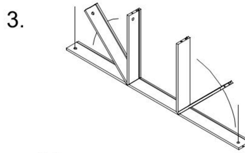
Собрать ящики. В фолдинги вставить шканты(1). Согнуть фолдинги, установить в продольный паз фолдинга дно ящика. Присоединить переднюю панель (XI) и затянуть отверткой стяжки-эксцентрики (16) на боковых панелях . Присоединить переднюю панель и затянуть отверткой, поворачивая по часовой стрелке, стяжки-эксцентрики (16) на боковинах. К передней панели привинтить ручку имеющимися при ней винтами. Прикрепить к боковым панелям направляющие(9)
