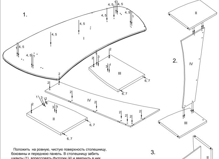
Положить на ровную, чистую поверхность столешницу, боковины и переднюю панель. В столешницу забить шканты (1), впрессовать футорки (4) и ввернуть в них стойки к эксцентрику (5). Забить в боковины шканты (1), ввернуть дюбеля стяжек-эксцентриков (3), впрессовать крепежи для опоры (6) и ввернуть в них опоры (7).
